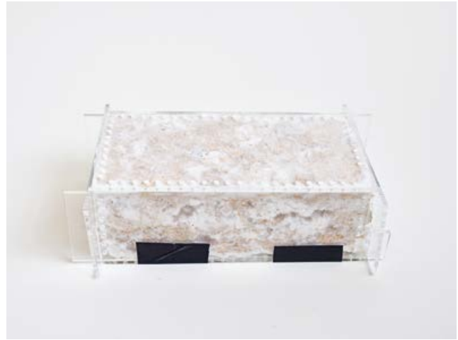
Baustoffherstellung aus Pilzmyzel (im Uhrzeigersinn): 1. Der Rohstoff Hanf wird mit Weizenkleie, Wasser und einem Pilz aus der Petrischale vermengt. 2. Abgefüllt in einem Beutel mit geschützter Luftzufuhr, lagert das Gemisch in einem «Growth Room». 3. Der Pilz gedeiht in dem Rohstoff, sein weißes Wurzelwerk ist von außen bald gut zu sehen. 4. Umgefüllt in eine Plexiglasform mit Luftlöchern, wächst das Myzel schließlich zur Ziegelsteinform heran.
