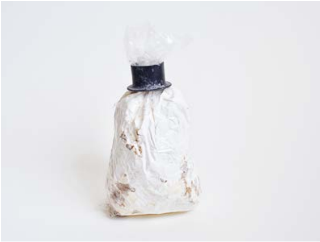
Baustoffherstellung aus Pilzmyzel (im Uhrzeigersinn): 1. Der Rohstoff Hanf wird mit Weizenkleie, Wasser und einem Pilz aus der Petrischale vermengt. 2. Abgefüllt in einem Beutel mit geschützter Luftzufuhr, lagert das Gemisch in einem «Growth Room». 3. Der Pilz gedeiht in dem Rohstoff, sein weißes Wurzelwerk ist von außen bald gut zu sehen. 4. Umgefüllt in eine Plexiglasform mit Luftlöchern, wächst das Myzel schließlich zur Ziegelsteinform heran.
