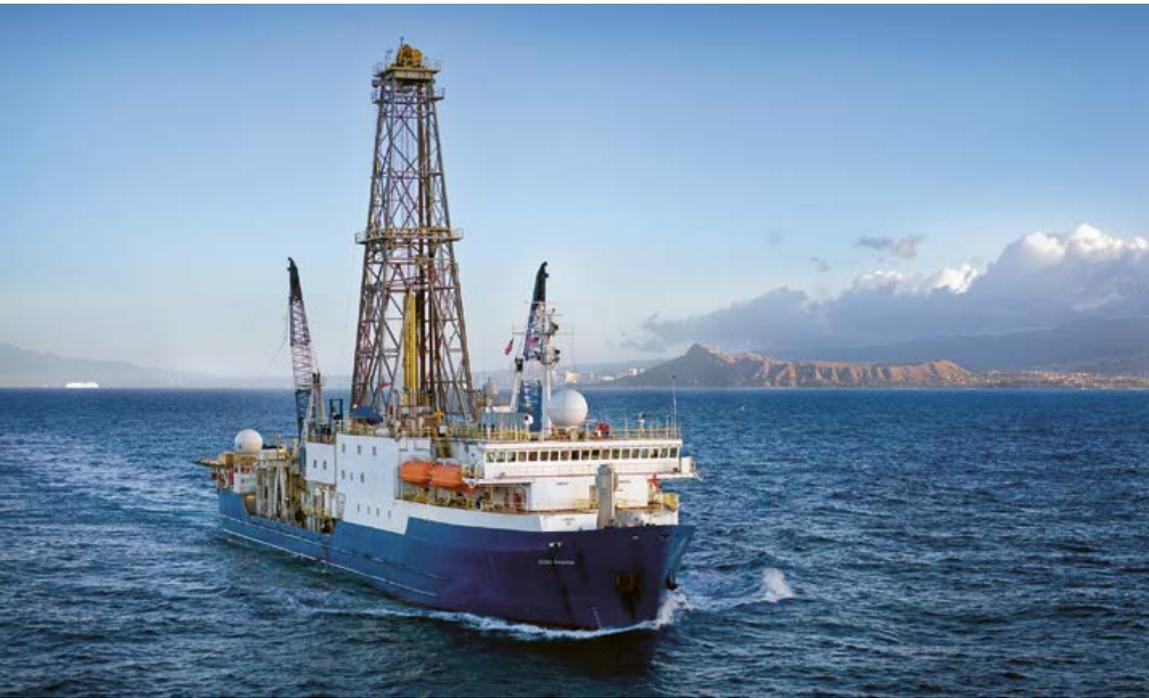
Die «Joides Resolution» ist Bohrschiff und schwimmendes Labor. Sie kann auch bei Wassertiefen von über 7.000 Metern eingesetzt werden und bohrt bis zu 2.100 Meter in den Meeresgrund. \* Foto: IODP
